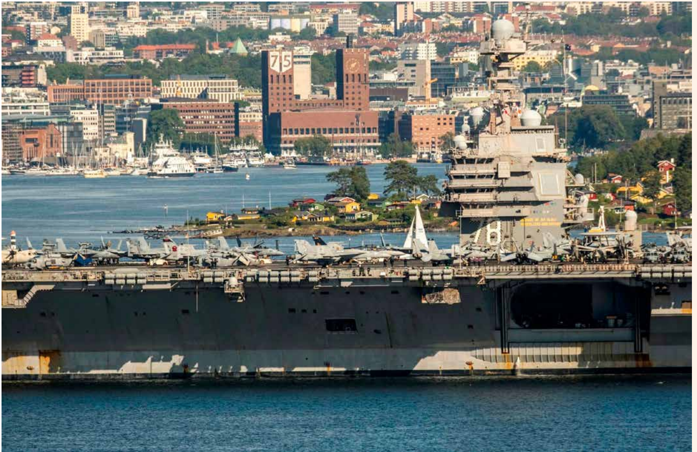
Verdens største hangarskip – USS «Gerald R. Ford», med to stk. A1B reaktorer som hver yter 700 MW termisk effekt som gir 350 000 hk til propellakslinger og 125 MW elektrisitet. Foto: Hans Kristian Riise/Oslo Havn
